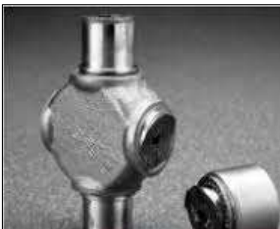
Figura 36 – Falha da cruzeta da junta universal devido a sobrecarga
