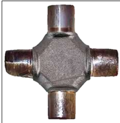
Figura 38 – Falha da cruzeta devido à lubrificação deficiente
