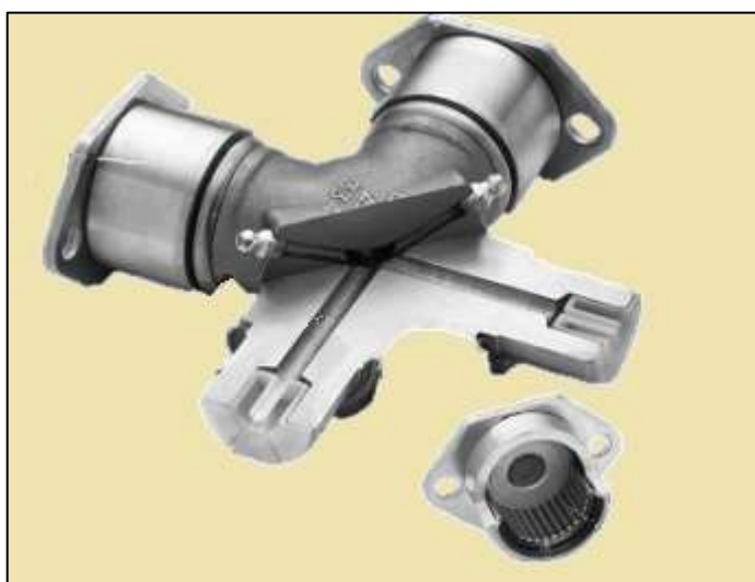
Figura 13 – Canais de lubrificação da cruzeta de junta universal
