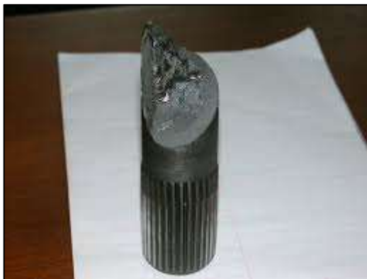
Figura 32 - Falha da haste entalhada devido a sobrecarga (boa dureza do núcleo)
