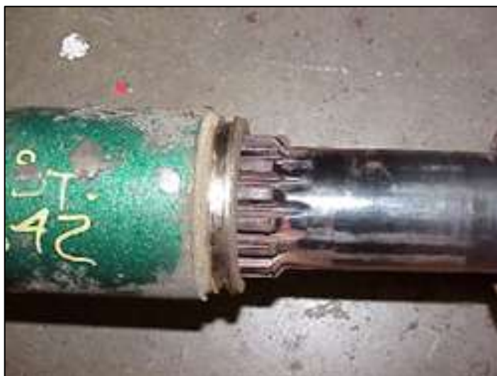
Figura 34 – Falha da haste entalhada devido a vedação deficiente
