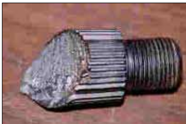
Figura 33 – Falha da haste entalhada devido a fadiga
