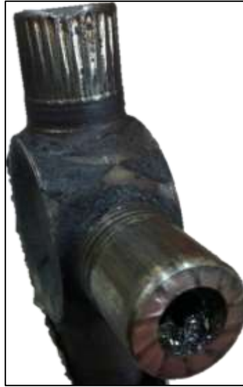
Figura 37 – Falha da cruzeta devido a pressão de contato
