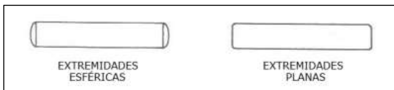
Figura 25 – Padrão de contato dos rolos do rolamento da junta universal
