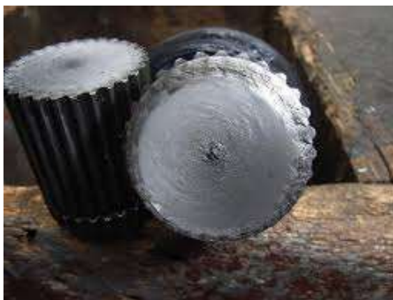
Figura 31 – Falha da haste entalhada devido a sobrecarga (baixa dureza do núcleo)
