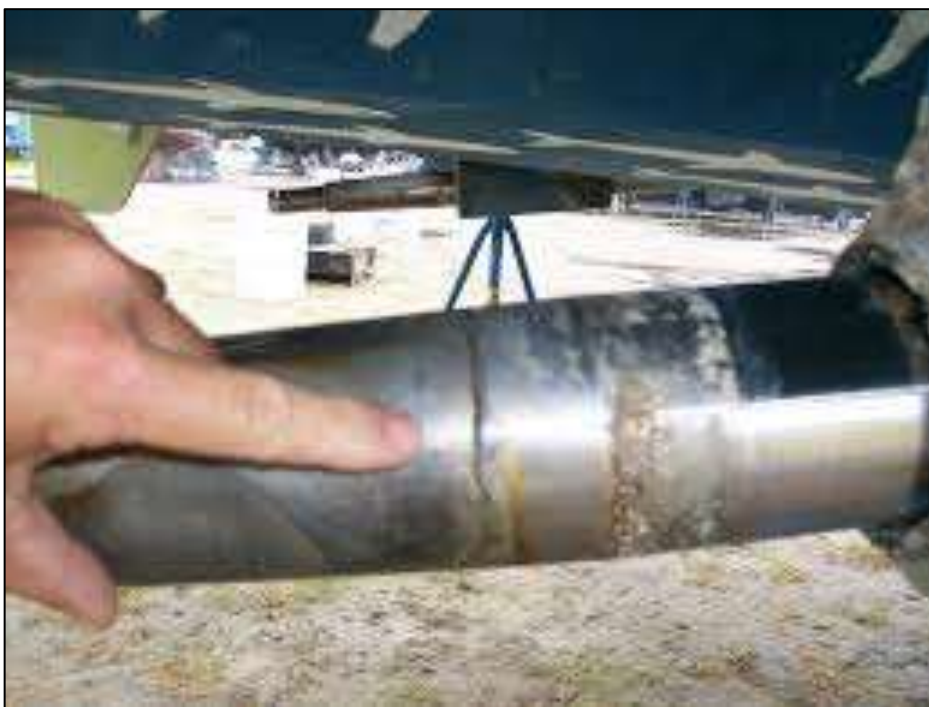
Figura 30 – Falha do tubo devido a fadiga
