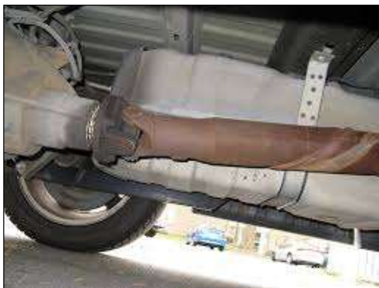
Figura 29 – Falha do tubo devido a sobrecarga
